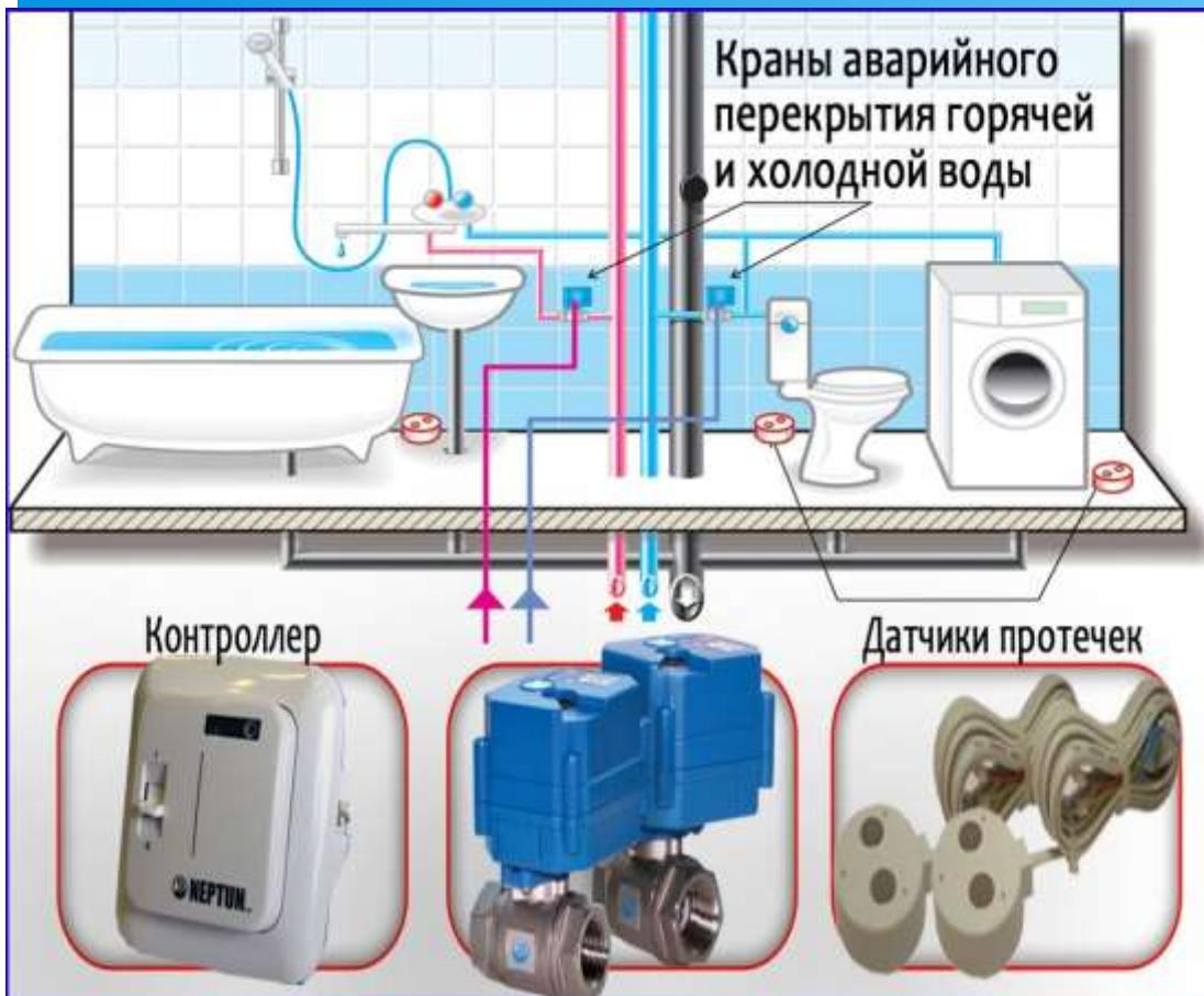
Позволяет контролировать все водопроводные соединения и в случае протечки автоматически перекроет вентиль.
